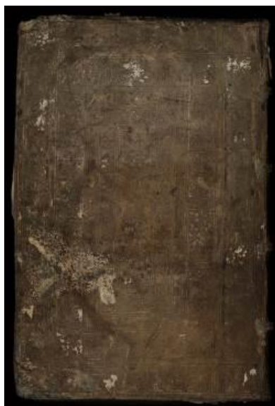
Velmi silné napadení pergamenové vazby a papíru plísněmi v důsledku nadměrné vlhkosti a vysoké teploty (foto archiv NPÚ)
