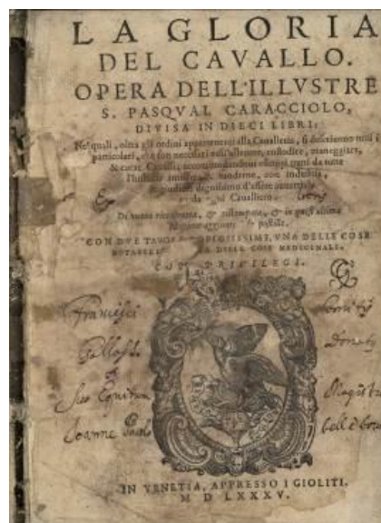
Velmi silné napadení pergamenové vazby a papíru plísněmi v důsledku nadměrné vlhkosti a vysoké teploty (foto archiv NPÚ)
