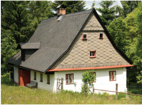
7. Dřevěné domkářské stavení čp. 164 v údolí na horním toku Boříkovického potoka. Jeho typologické znaky, zejména vysoký tvar střechy s námětky, předsazený štít a tesařské detaily roubení mohou odkazovat k době kolem roku 1800. K roku 1880 zde žila rodina pletaře a vyšivače Josefa Kühna se sedmi dětmi. (SL)
