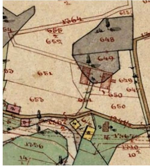
3-28 Lichkov, dům č. 15 je na štítu datovaný do roku 1872, kdy došlo k přesunu dvora usedlosti kvůli výstavbě železnice. Celá usedlost byla přesunuta do zadní části svých polností, jak je vidět na výřezu z originální mapy stabilního katastru, kde je usedlost zakreslena červenou šrafurou v paralelní dispozici na st. p. č. 4. Původní usedlost, žlutě značená st. p. č. 4, 5, musela ustoupit železniční trati. Dům má roubenou světnici, jejíž trámy mohou pocházet ze starší roubené stavby, a sedlovou střechu s lichoběžníkovým štítem, doplněným místně netradičním podlomením z roku 1872. (ČÚZK)
